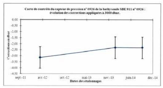
Validité de l'étalonnage du capteur de pression : 1 an.
