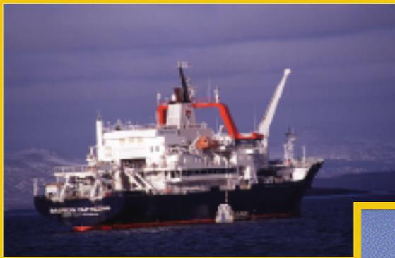
Le *Marion-Dufresne* (IFRTP), brise-glace dédié plus particulièrement à l'océan Austral, équipé d'un carottier permet le prélèvement de carottes de sédiments longues de 60 mètres.
