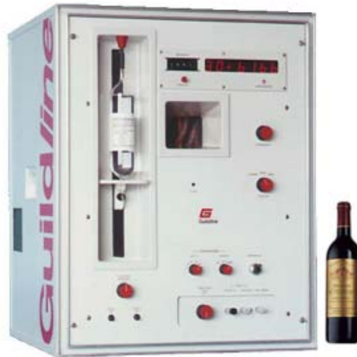
FIG. 5 – Ce salinom tre contient un r servoir de 18 l d'eau, r gul  au centi me de degr . Il peut  tre vid  pour faciliter le transport (la bouteille de Bordeaux donne l' chelle, mais ne figure pas au catalogue du constructeur).
