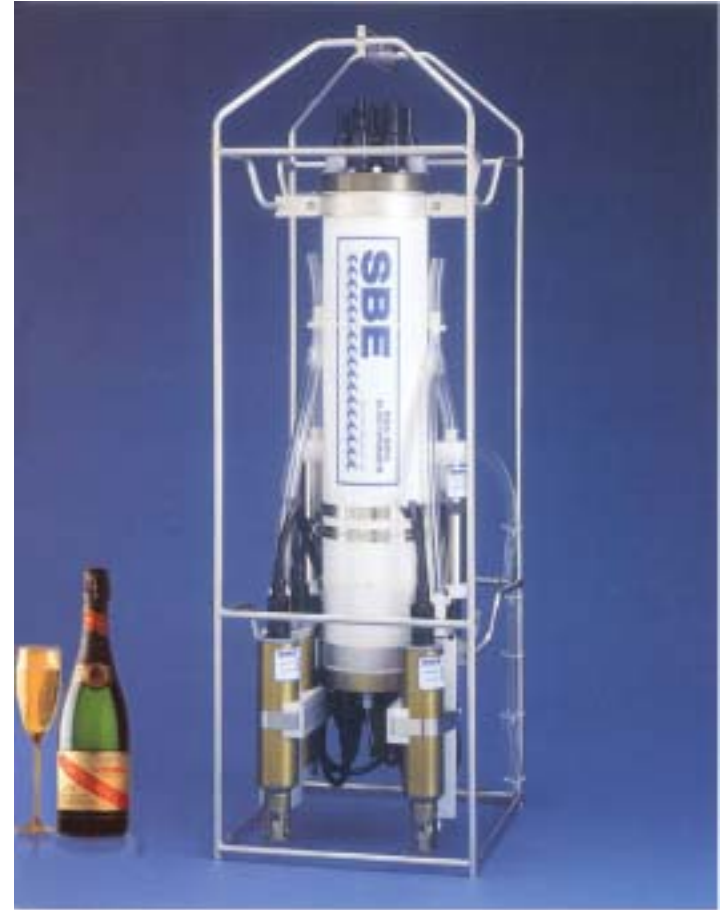
FIG. 6 – Les sondes CTD sont  quip es de capteurs de conductivit , de temp rature et de pression. Elles comportent souvent des capteurs additionnels : oxym tre, fluorim tre etc... Elles sont, soit autonomes et immerg es   l'aide d'un c ble en acier ordinaire, soit reli es au navire par un c ble  lectro-porteur qui alimente la sonde et retransmet au fur et   mesure   l'unit  de pont les donn es mesur es. La fr quence d'interrogation des diff rents capteurs peut  tre de 8 par seconde. Avec une vitesse de descente de la sonde de 1 \text{ m}\cdot\text{s}^{-1} , l' chantillonnage vertical est r alis  tous les 12 cm environ. http://www.seabird.com
