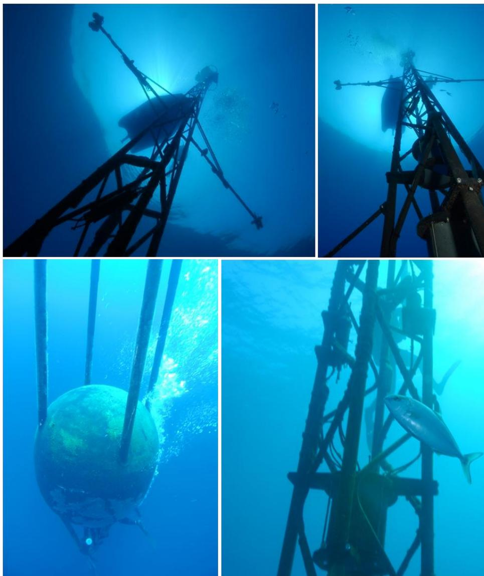
**Figure 3-4 : Photographies prise lors de campagnes mensuelles montrant la partie immergée de la bouée. Les capteurs d'éclairage sont fixés à l'extrémité des bras horizontaux pour minimiser l'ombrage.**
