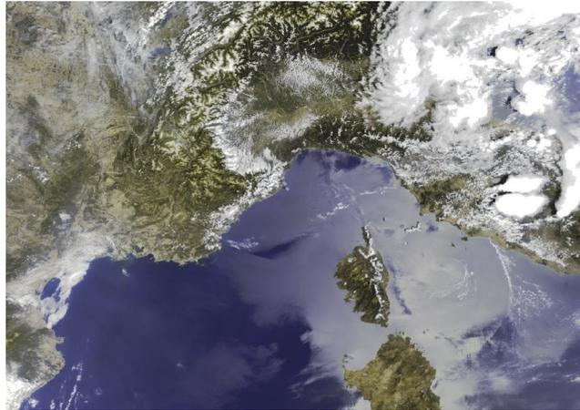
FIG. 2.1 – Une scène observée par MERIS (29/06/2003) en mer méditerranéenne où l’observation de l’océan est contaminée par le sun glint, sur la partie droite de l’image. Les importantes variations locales de l’intensité du sun glint illustrent le fait qu’on ne peut pas estimer ce signal d’après la vitesse du vent.
