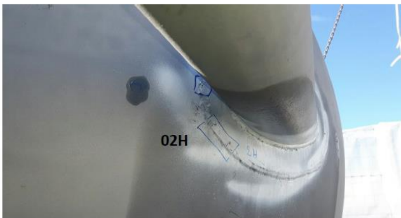
Présence de deux zones de porosité sur la soudure du renfort
