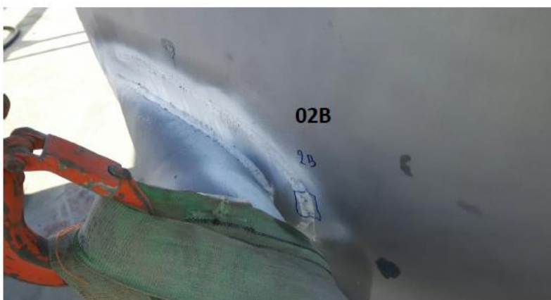
Présence d'une zone de porosité sur la soudure du renfort
