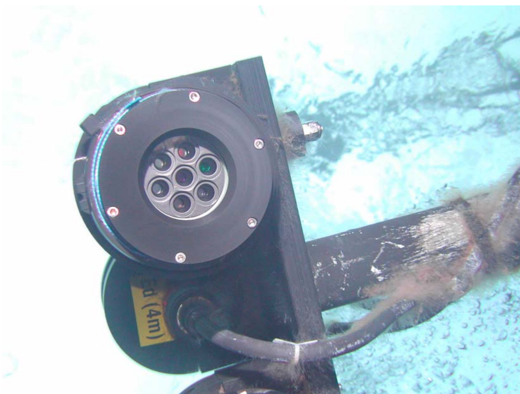
- 4m (photo A) : radiomètre inférieur – APRES NETTOYAGE
