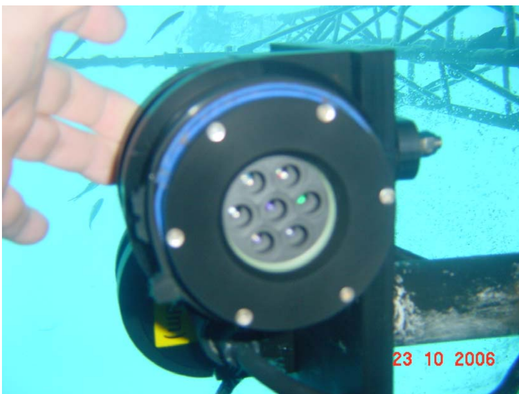
- 9m (photo B) : radiomètre inférieur – APRES NETTOYAGE
