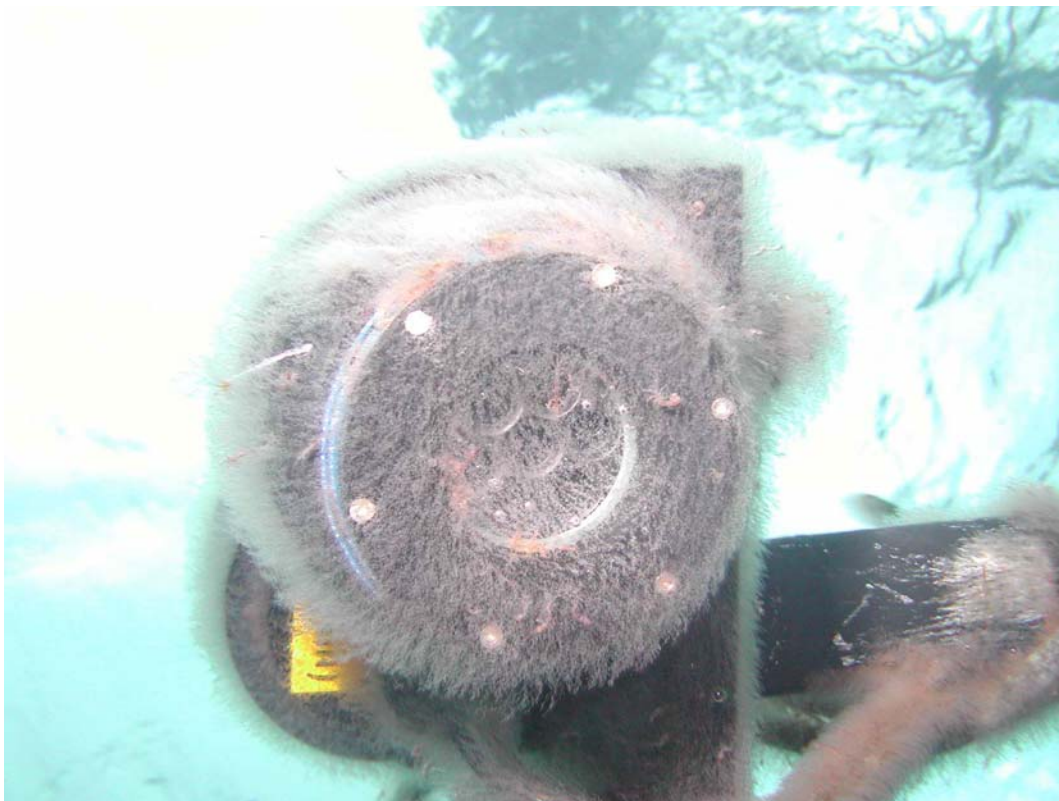
- 4m (photo A) : radiomètre inférieur – AVANT NETTOYAGE
