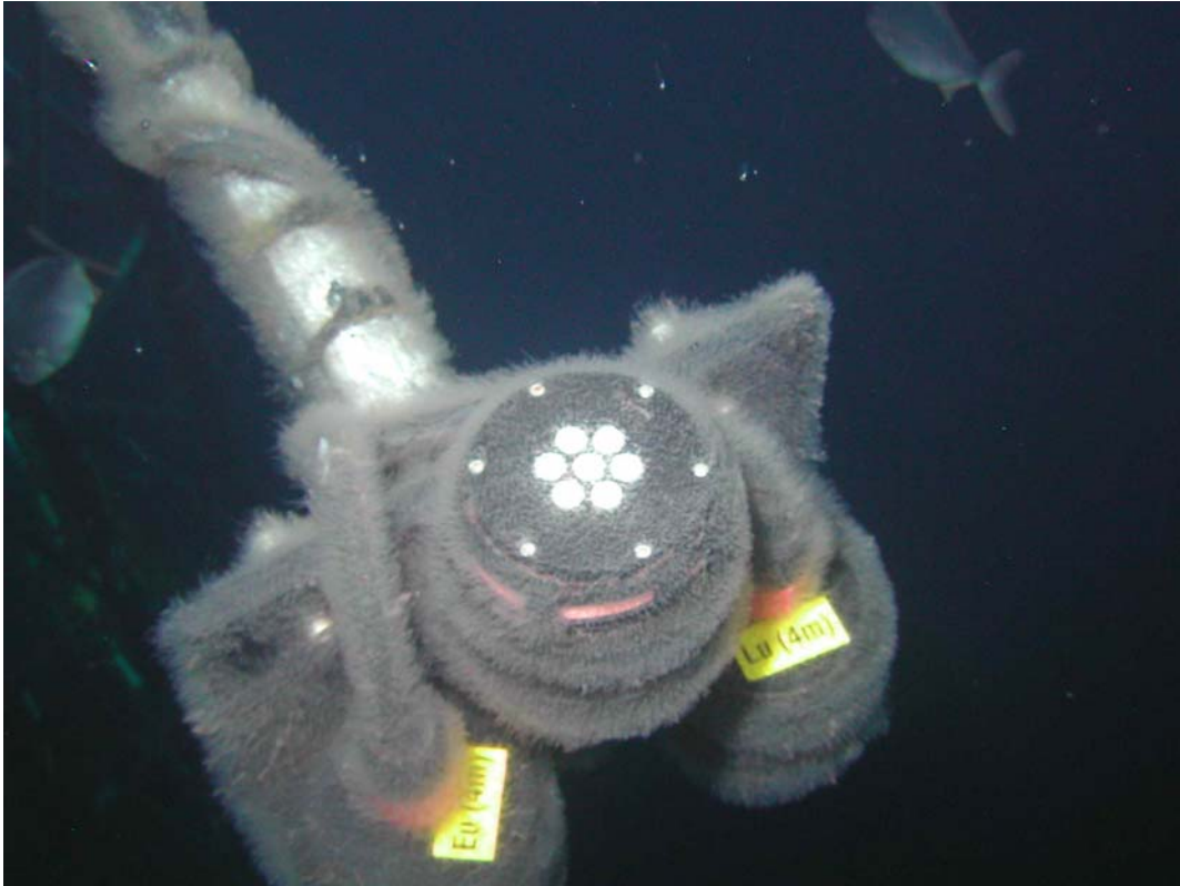
- 4m (photo A) : radiomètre supérieur – AVANT NETTOYAGE
