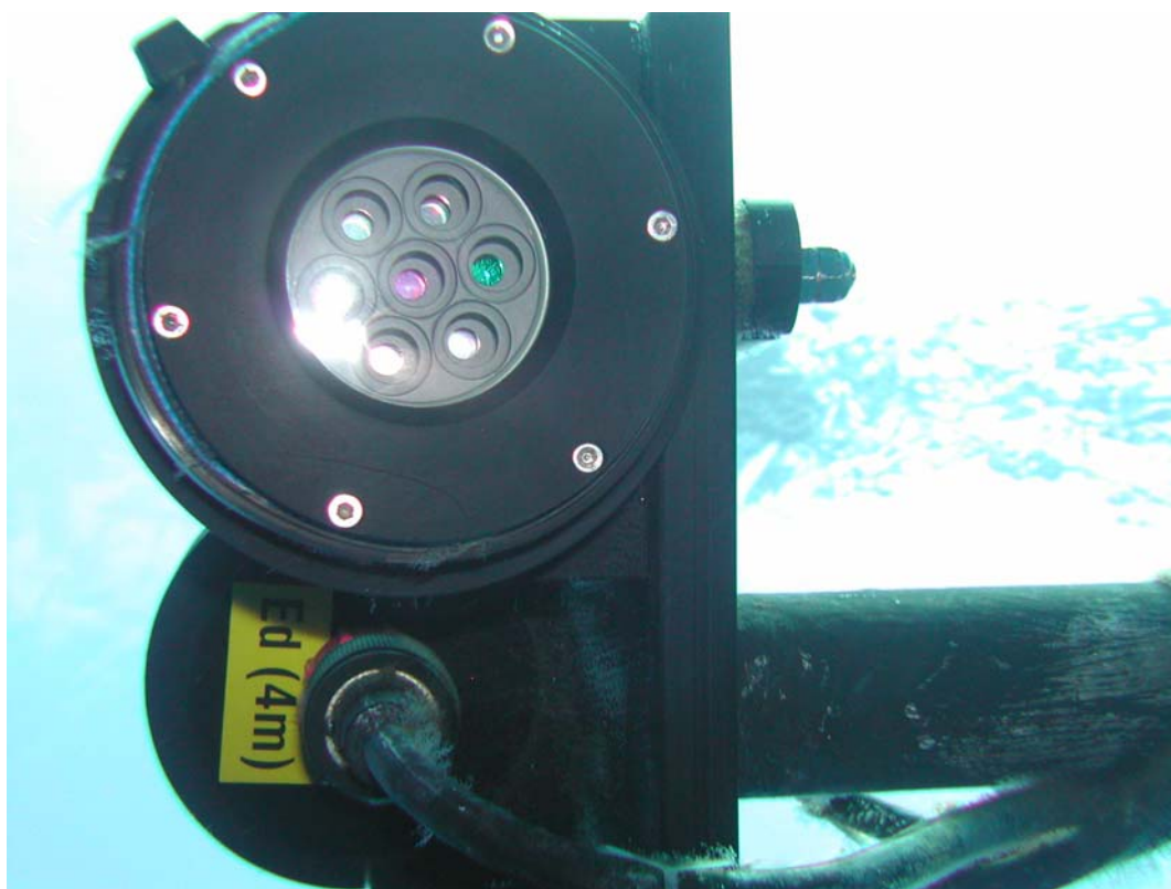
- 4m (photo A) : radiomètre inférieur – APRES NETTOYAGE
