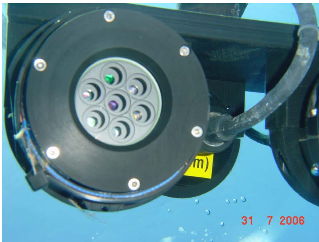
- 4m (photo A) : radiomètre inférieur – APRES NETTOYAGE
